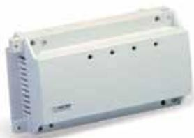
Коммутационный модуль основной (главный, master) для 4 или 6 зон для подключения проводных термостатов (серий WFHT, Milux, BT) к сервоприводам (22СХ, 26LC), реле насоса (8 А), IP 20, модульная конструкция. К каждой зоне можно подключить от 1 до 4 сервоприводов 22СХ, 26LC. Светодиодная индикация состояния. Степень защиты IP20.
