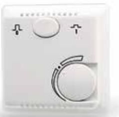
Электронный комнатный термостат скрытого монтажа. Диапазон регулирования температуры от 5 до 30 °С, шаг 0,5 К. На контактах: 15 А, 230 В. Степень защиты IP30, переключатель вкл.-выкл, возможность подключения внешнего датчика.
