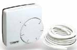
Электронный комнатный термостат для систем напольного отопления. Подключение к сервоприводам 22СХ и 26LC либо напрямую, либо через коммутационный модуль WFHC. Выбор типа сервопривода (Н.О. - Н.З. ) осуществляется при помощи встроенного переключателя, находящегося под крышкой корпуса.
