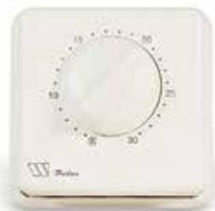
Электромеханический комнатный термостат с термочувствительной диафрагмой, имеет три контакта. Диафрагма из нержавеющей стали. Фиксация установленной температуры на обратной стороне вращаемого регулятора. Диапазон регулирования: 5- 30 °С. Гистерезис при 20 °С составляет 0,8 К. На контактах до: 10 (2,5) А – 250 В. Контакты с серебряным покрытием 1000-1000. Степень защиты IP30.
