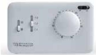
Электронный термостат для двухтрубных фанкойлов. Переключатель вкл.-выкл. (исключает термостат из цепи). Переключатель на три скорости вентилятора. Переключатель зима-лето.
