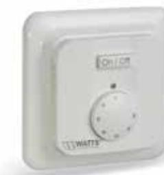
Электронный комнатный термостат скрытого монтажа для электрического напольного отопления. Диапазон регулирования 5 - 35 °С шагом 0,5 К. Выход 250 В / 10 А. Светодиодная индикация. В комплект термостата входят наружный датчик 10 К, кабель 3м, набор из 2 монтажных рамок (круглая и квадратная). Соответствует двум стилям двух крупных поставщиков электрических «теплых полов»: ELKO RS/B&J JUSSI and ELJO TREND.
