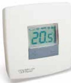
Цифровой комнатный термостат с ЖК - дисплеем для систем отопления и охлаждения. Температурный диапазон 5 – 37 °С. Гистерезис при 20 °С составляет 0,5 К. На контактах до: 8 А – 250 В. Имеется функция отключения термостата. Простое подключение – два провода. Степень защиты IP30.
