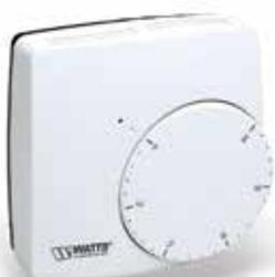
Электронный комнатный термостат для систем напольного отопления. Подключение к сервоприводам 22СХ и 26LC либо напрямую, либо через коммутационный модуль WFHC. Режимы работы: комфортный, ночной, управление от таймера. Светодиодная индикация состояния. Диапазон регулирования 5 – 30 °С, гистерезис 0,5 К. Регулирование по встроенному термодатчику или по внешнему датчику (опция: Sensor 10K, стр. 85). Бесшумные триаковые контакты. Мощность до 15/75 Вт. Степень защиты IP30.
