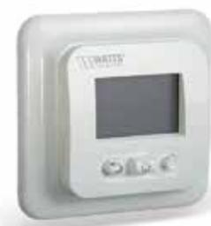
Электронный комнатный термостат скрытого монтажа с ЖК - дисплеем для электрического напольного отопления или управления работой циркуляционного насоса. Диапазон регулирования 5 - 37 °С шагом 0,5 К. Выход 250 В / 10 А. 3 типа регулирования (см. ВТD) В комплект термостата входят наружный датчик 10 К, кабель 3м, набор из 2 монтажных рамок (круглая и квадратная). Соответствует двум стилям двух крупных поставщиков электрических «теплых полов»: ELKO RS/B&J JUSSI and ELJO TREND.
