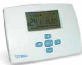
Электронный комнатный термостат с ЖК-дисплеем с дневным (Daily) или недельным (Weekly) программированием для систем отопления и охлаждения. 9 заводских и 4 пользовательские программы. Подключение к **нормально закрытым** сервоприводам 22СХ и 26LC либо напрямую, либо через коммутационный модуль WFHC.
