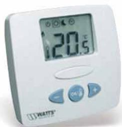
Электронный комнатный термостат с ЖК - дисплеем для систем отопления или охлаждения. Подключение к сервоприводам 22СХ и 26LC либо напрямую, либо через коммутационный модуль WFHC. Выбор типа сервопривода (НО - НЗ ) осуществляется в меню параметров.
