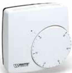
Электронный комнатный термостат для систем напольного отопления. Подключение к сервоприводам 22СХ и 26LC либо напрямую, либо через коммутационный модуль WFHC. Режим работы: комфортный (поддерживает заданное значение температуры воздуха круглосуточно). Светодиодная индикация состояния. Диапазон регулирования: 5–30 °С, гистерезис 0,5 К. Регулирование по встроенному термодатчику. Бесшумные триаковые контакты. Мощность до 15/75 Вт. Степень защиты IP30.
