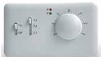
Электронный термостат для четырехтрубных фанкойлов. Переключатель вкл.-выкл. (исключает термостат из цепи). Переключатель на три скорости вентилятора. Переключатель зима-лето.
